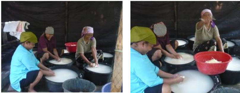
Gambar 6. Penghilangan pith dan penghancuran.
